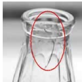
口側面ひび割れ
